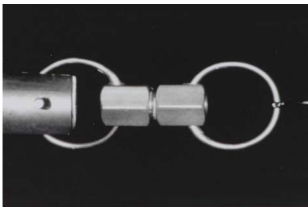
Figura 2. Fotografia do conjunto, pronto para a máquina de ensaio, mostrando os parafusos acoplados nas duas porcas sextavadas e as argolas de aço
