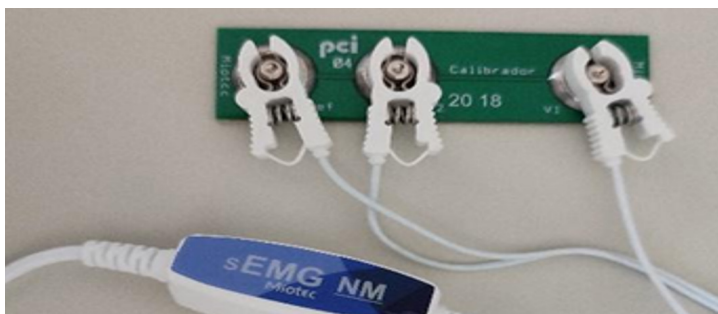
Figura 12 – Aferição da placa de calibração e eletrodos pelo fabricante
