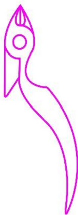
Figura 6 – Vista superior da geometria das pernas/ cabos do alicate da marca Onna
