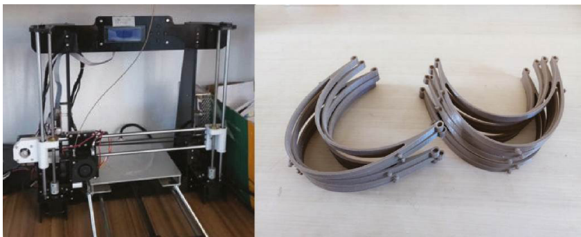
Figura 3 - Impressora 3D utilizada e suporte dos face shields
