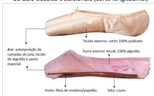
Figura 2 – Materiais que constituem as sapatilhas de ponta do balé clássico tradicionais (corte longitudinal)
