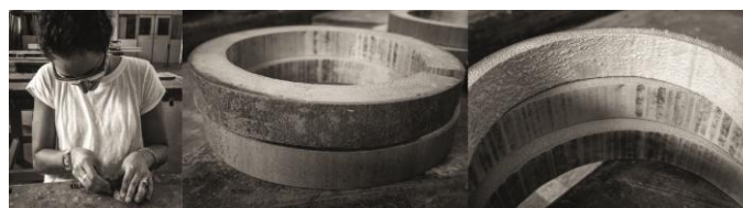
Figura 12: Limpeza dos anéis com a folha abrasiva nas partes externa e interna. Fonte: Autor.
