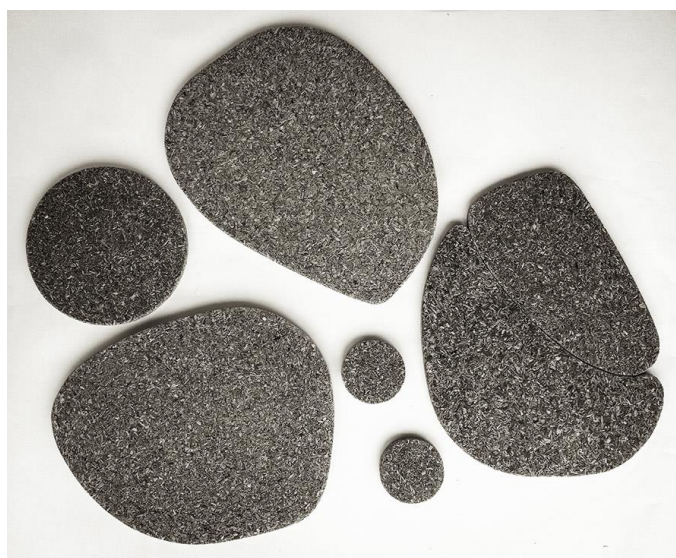
Figura 24: Sospplat de aglomerado de resíduo de bambu. Fonte: Autor.
