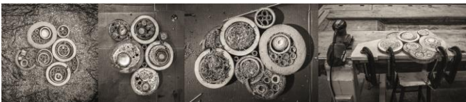
Figura 15: Preenchimento dos anéis com o composto de cola branca e resíduo de bambu. Fonte: Autor.
