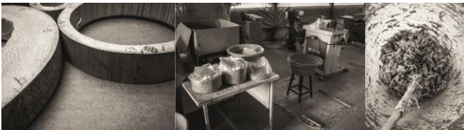
Figura 14: Fixação dos anéis de maior diâmetro com fio de arame galvanizado; processo de separação dos resíduos por meio de peneiras; composto de cola branca e resíduo (1:3). Fonte: Autor.
