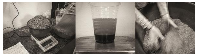
Figura 19: Pesagem dos resíduos e dosagem da resina; mistura da resina com resíduos. Fonte: Autor.
