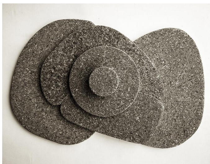
Figura 25: Sospplat de aglomerado de resíduo de bambu. Fonte: Autor.
