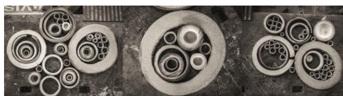
Figura 12: Limpeza dos anéis com a folha abrasiva nas partes externa e interna. Fonte: Autor.
