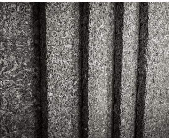
Figura 21: Chapas de aglomerado de resíduo de bambu. Fonte: Autor.
