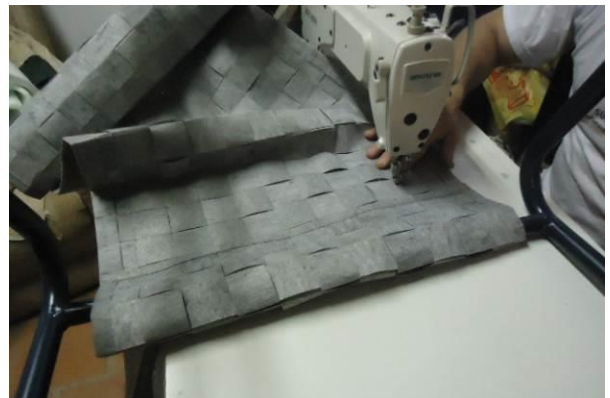
Figura 19 - Costura do tramado na estrutura.
