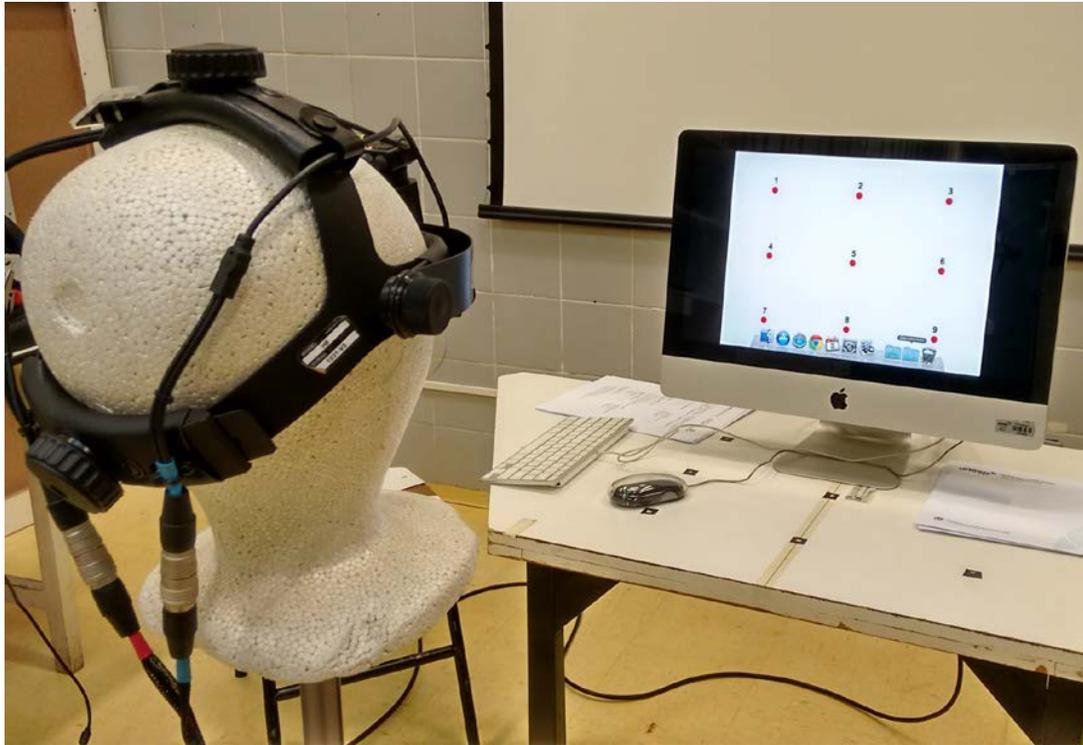
**Figura 1:** Equipamento Eye traker e monitor para calibração, usados para coleta de dados em pesquisa com disléxicos, alocado no Laboratório de Informação, Visão e Ação - LIVIA, pertencente ao Departamento de Educação Física, Unesp, Bauru, SP, Brasil[1][S2][S3][4]. (fonte: as autoras).
