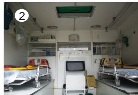
Fotos 1 e 2: nestas fotos é possível observar a altura das macas sobre os reservatórios de água o que acaba dificultando alguns processos de manutenção à vida.
