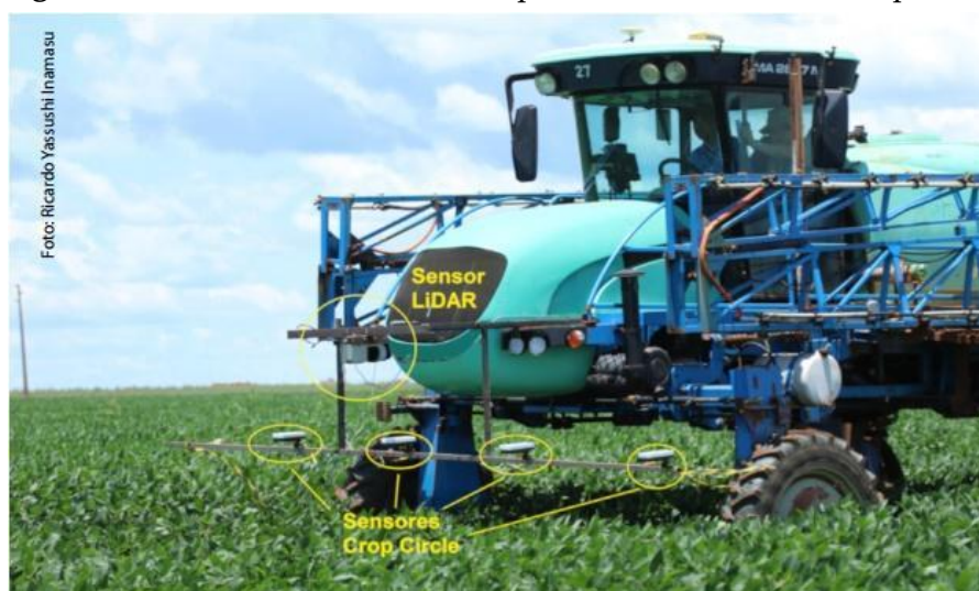
Figura 1 – ARABIC 1 – Sensores acoplados a um trator no campo
