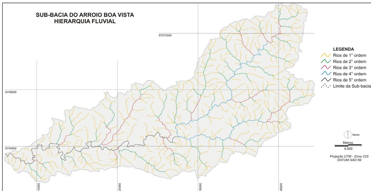
**Figura 1** - Ordem hierárquica da sub-bacia do arroio Boa Vista, segundo Strahler (1952).
