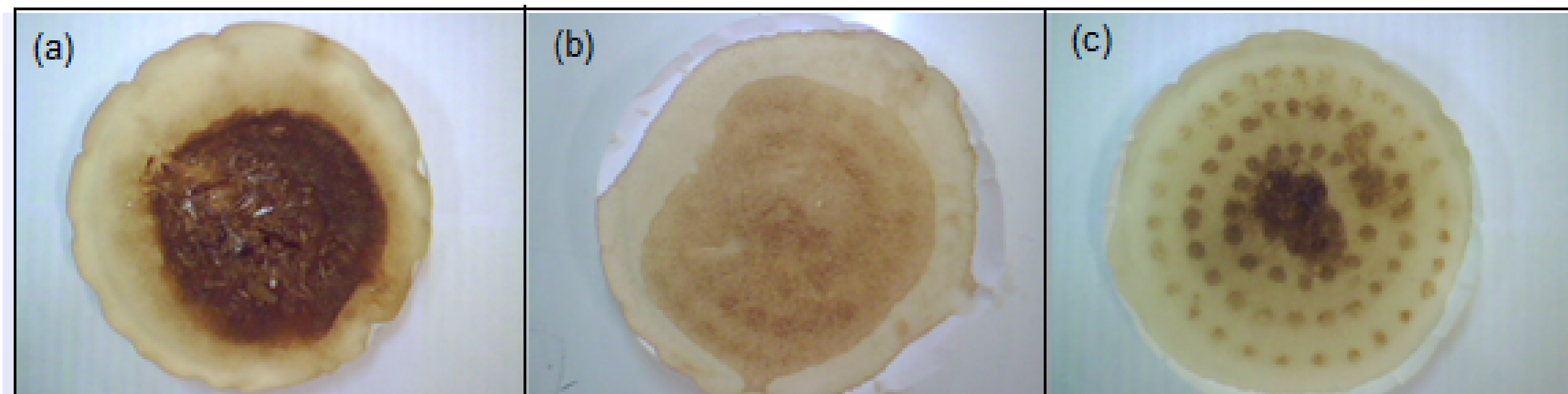
Figura 01: Rendimento da extração dos cristais de lapachol bruto nos referido solventes : (a) Éter (b) Acetona (c) Água destilada.
